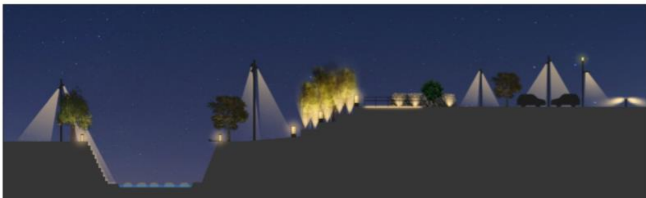
樹木ライトアップ、河川付近を照射している照明は消灯。（但し、竹林は点灯） その他の調光タイプの照明は、約50%で点灯。
